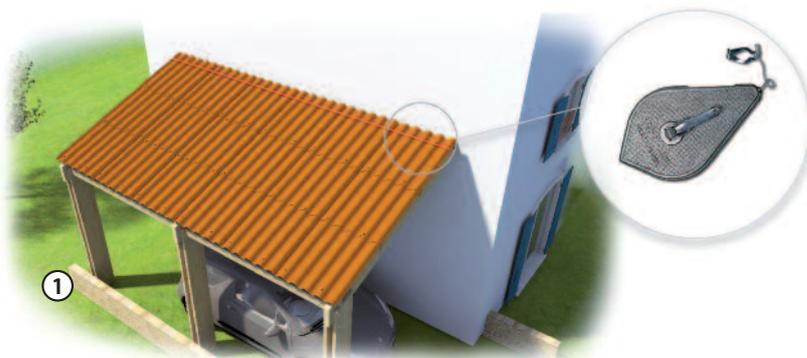
② Poser le 1<sup>er</sup> raccord de mur\* (sans coupe de coin) sur la plaque ondulée et fixer en sommet des 2<sup>ème</sup> et 5<sup>ème</sup> ondes à l'aide des vis autoperceuses. La pose s'effectue dans le même sens que la pose des plaques de droite vers la gauche.
