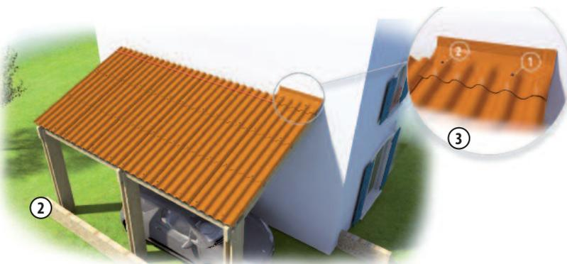
③ Poser le 2<sup>ème</sup> raccord de mur au niveau du trait de lignage. Il vient en recouvrement sur le 1<sup>er</sup> raccord de mur.
