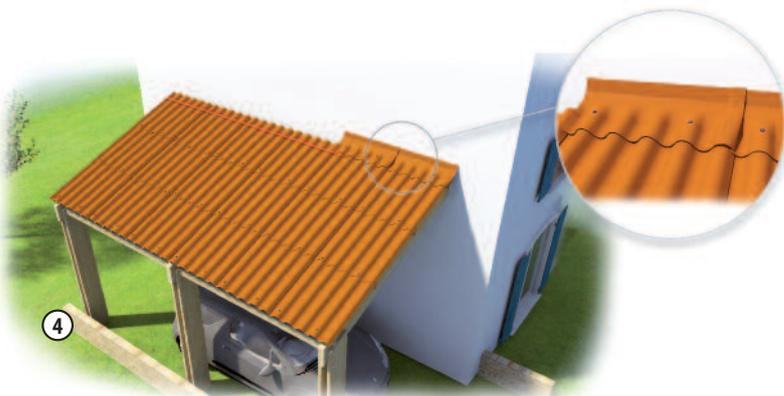
④ Fixer le raccord de mur en sommet de la 2<sup>ème</sup> et 5<sup>ème</sup> onde à l'aide des vis autoperceuses.
