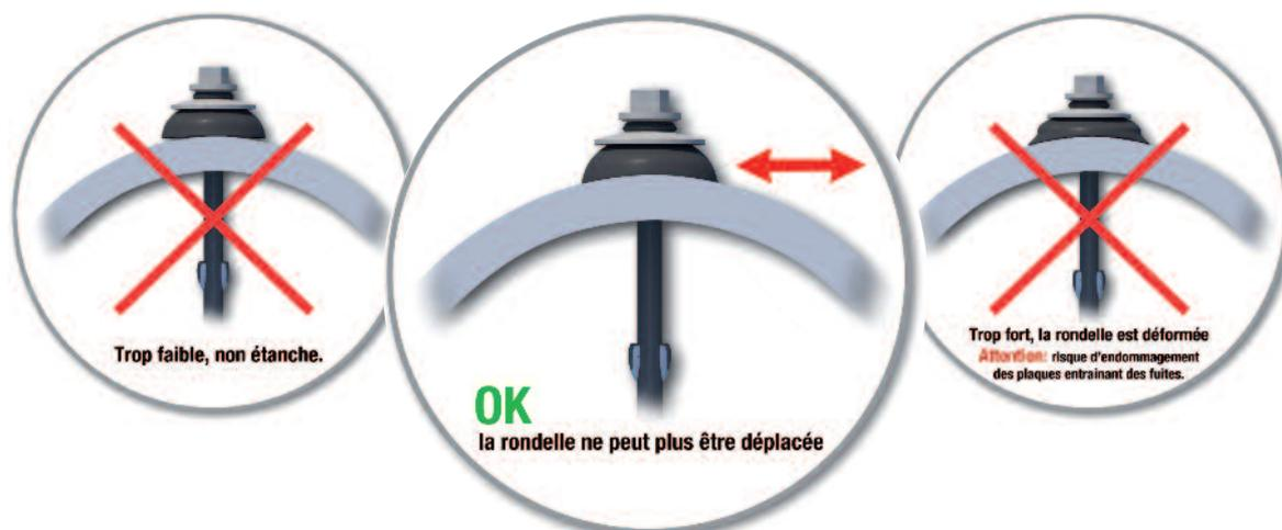
Pour l'ancrage des fixations des plaques aux éléments supports, sont exclus d'emploi, les outils de typologie analogue suivants : visseuse à chocs, boulonneuse, clef à chocs, perceuse visseuse avec mode percussion enclenché ou bien intégré par défaut, perforateur ou bien marteau perforateur.
