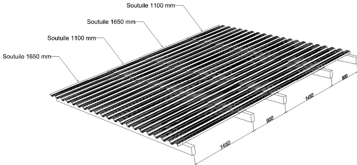
Figure 6 – Dimension chevêtre pour plaque à châssis
