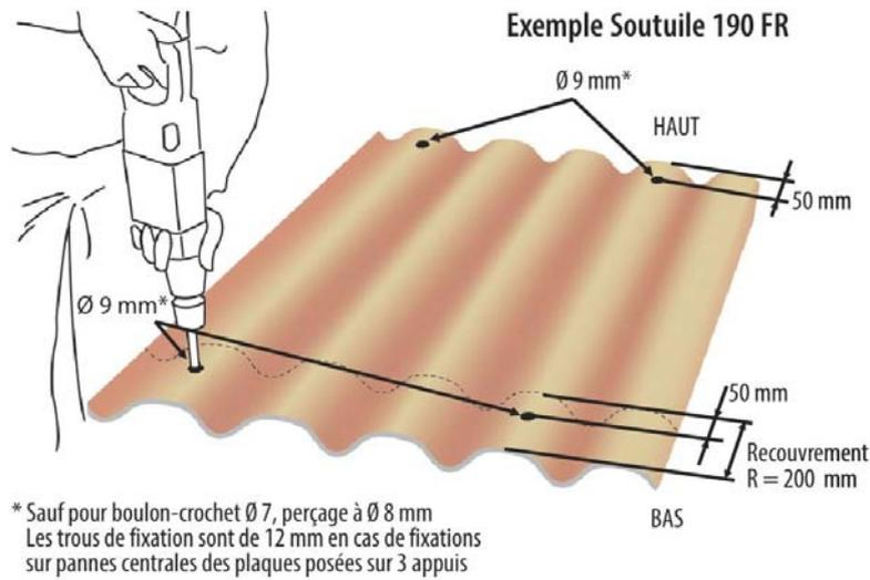
Figure 9 – Pose des compléments d'étanchéité
