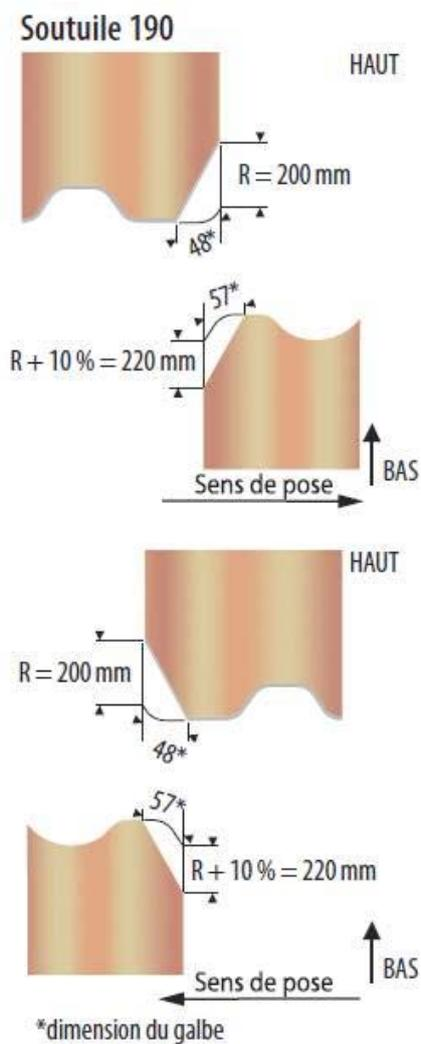
Figure 5 – Pose mixte avec des longueurs de plaques Soutuile 190 FR différente sur chaque ligne (3 fixations par appui)
