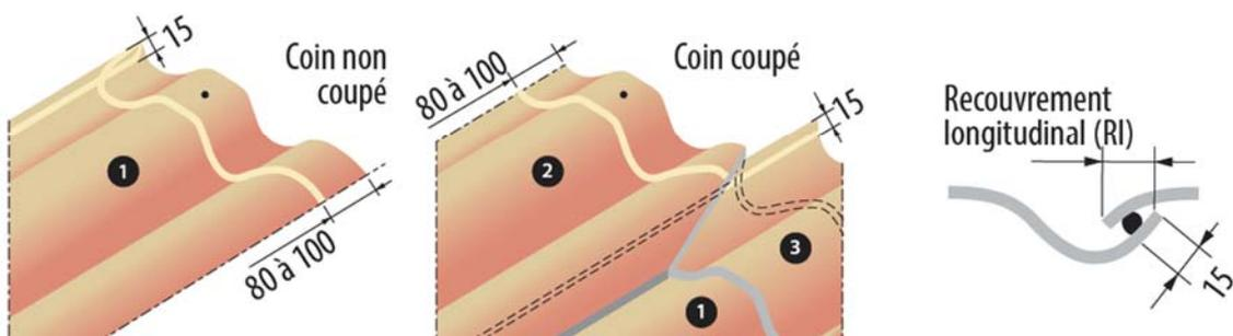
**Figure 10 – Faîtage ventilé avec une faîtière à charnière d'aération en fibres-ciment**
